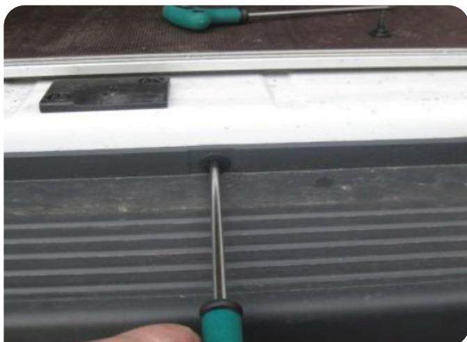
Kunststoffverkleidung der Stoßstange demontieren.
