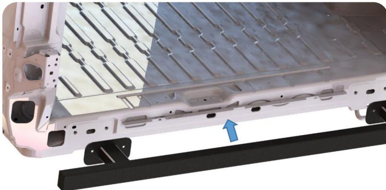
Anschließend Stoßstangenträger ohne den ange-schweißten Bolzen positionieren. Siehe Seite 4.
