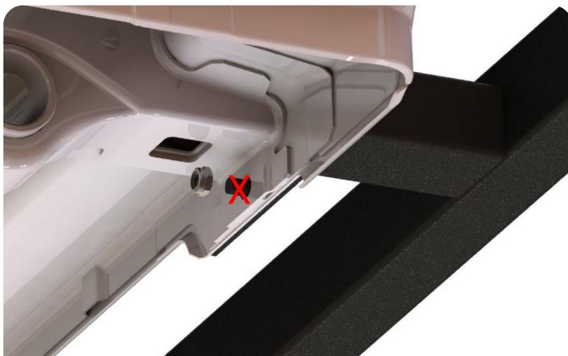
Der Stoßstangenträger wird ohne die angeschweißte Schraube montiert. Dafür den Kopf abschleifen und das Gewinde austreiben.
